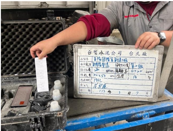
混凝土氯離子檢測
